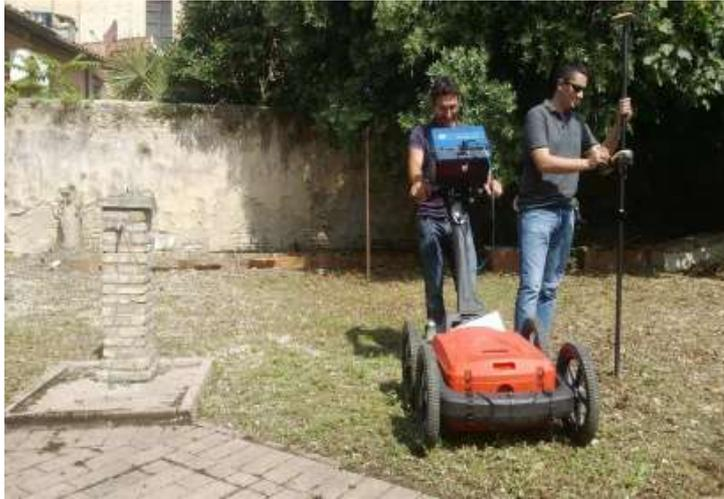
Figura 156 - Rilievo topografico in contemporanea alle indagini georadar
