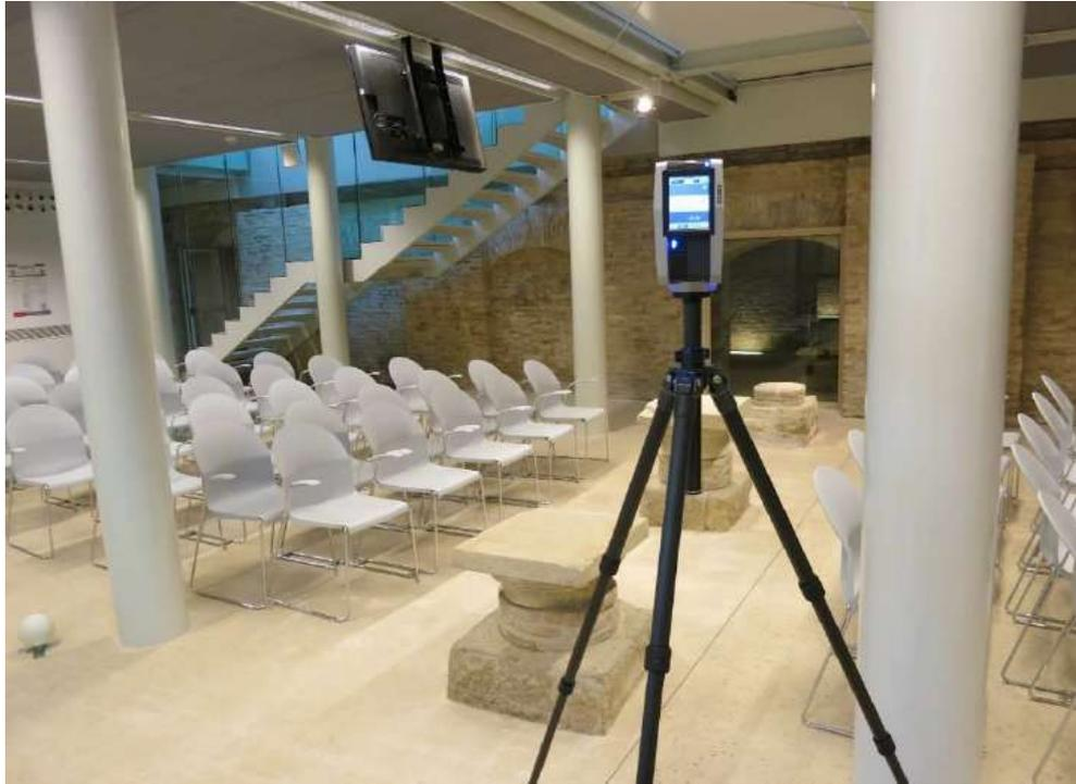
Figura 160 - Rilievo Laser Scanner alla Mediateca Montanari
