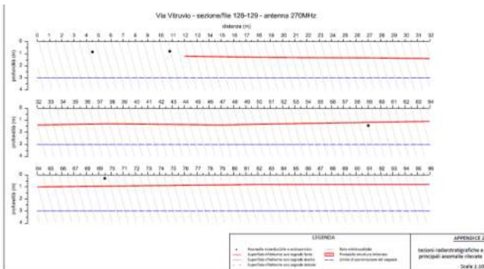
Figura 147 – Sezioni radarstratigrafiche e principali anomalie rilevate su via Vitruvio
